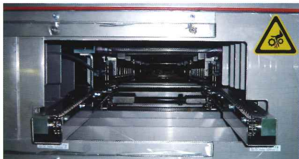
すだれの無い窒素ドーム構造 N 2 tunnel structure without blocking curtains
